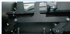
LIMPEZA AUTOMÁTICA DOS TURBULADORES
