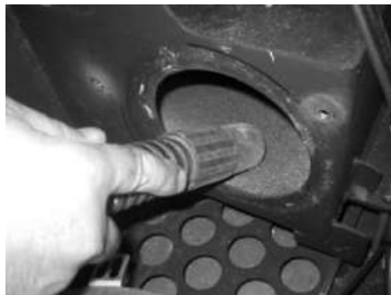
Figura 34 - Aspirar a zona de passagem do ar
