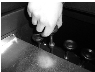
Figura 27 - Limpeza dos turbuladores
