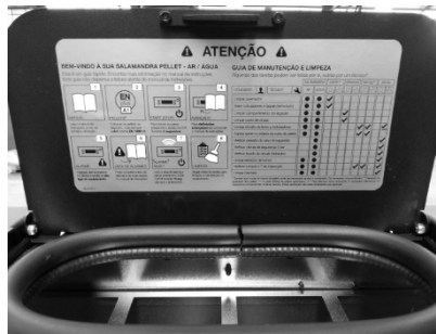
Figura 22 - Etiqueta com as tarefas de manutenção
