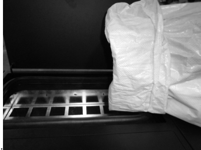
Figura 17 - Reabastecimento do depósito de pellets
