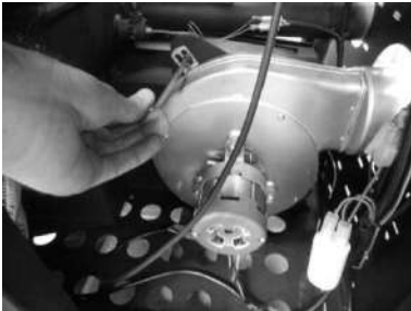
Figura 33 - a) Retirar os parafusos; b) Retirar extractor
