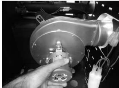
Figura 33 - a) Retirar os parafusos; b) Retirar extractor
