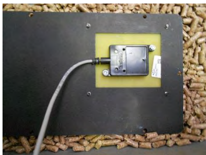
Figura 26 – Colocação do sensor sobre os pellets
