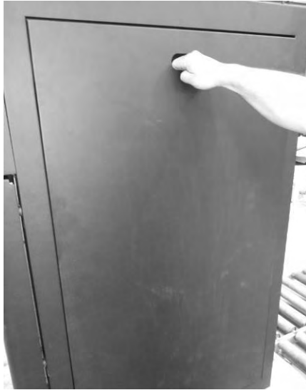
Figura 14 – remoção das capas laterais
