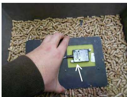
Figura 28 – Regulação da sensibilidade do sensor
